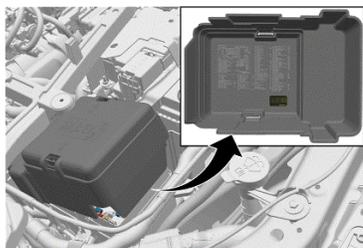
Si es necesario desactivar el claxon antes del transporte, ubique y retire el fusible del claxon del centro eléctrico debajo del cofre.
