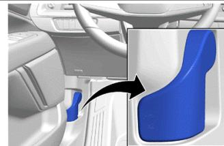
4. Retire la cubierta de acceso del lado derecho (si está equipado).
