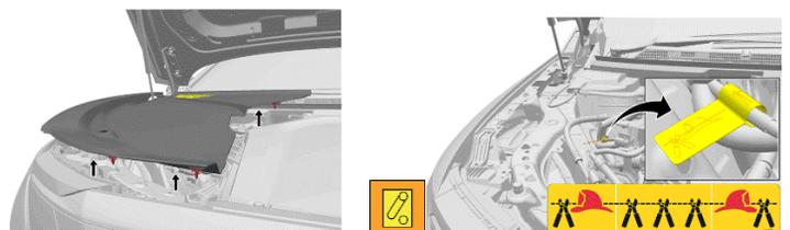
Las bolsas de aire se pueden desactivar retirando el cable negativo de la batería de 12V. Esto desactivará la alerta y mitigación de fuga térmica.
